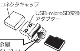
microSDカードの金属端子面を下にして差し込む
