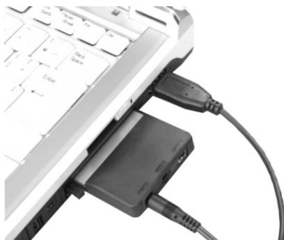
2. 反対側のコネクタを PC カードの [DC5V] 端子へ接続します。
