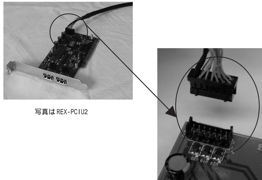
5. REX-PCIU2/PCIFU2 を PCI スロットに装着します。接続には十分に注意して装着してください。
