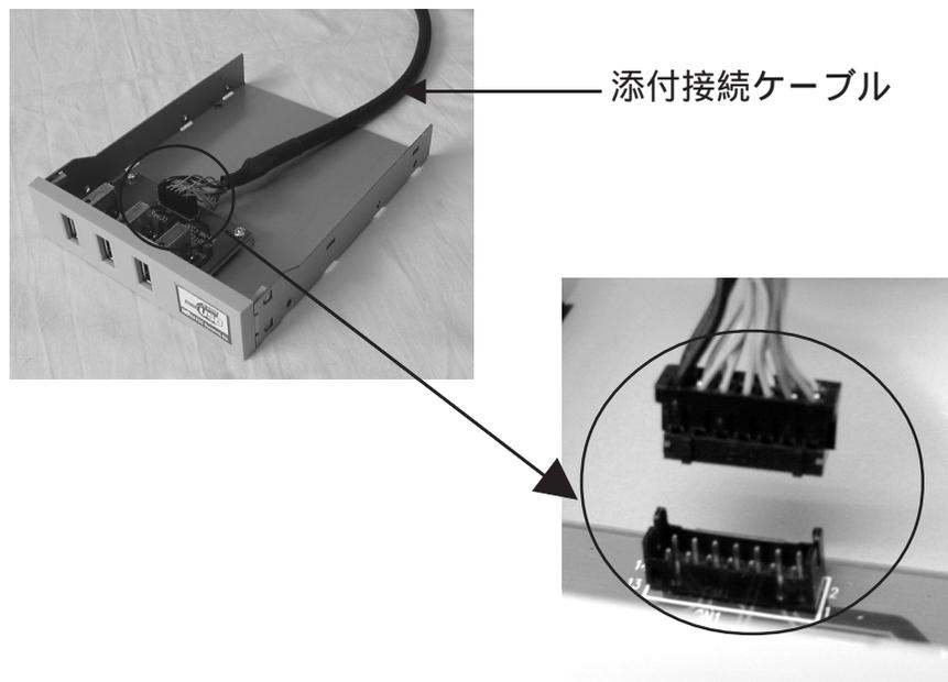
2. 接続ケーブルを取り付けた USB2.0 拡張フロントベイをパソコンの前方より挿入し、添付のネジを使用して固定します。
