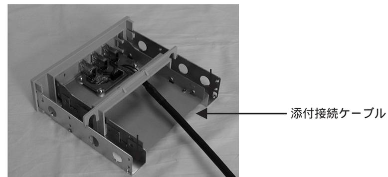
4. パソコンの前方より挿入し、添付のネジを使用して固定します。
