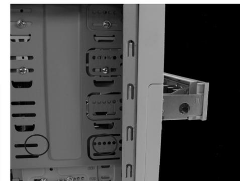
5. 「2-1. 項3.5 インチベイへの取り付け方法」のステップ 4. と 5 に従って、USB2.0 拡張フロントベイに取り付けた接続ケーブルのもう一方の端を REX-PCIU2/PCIFU2 に取り付け、REX-PCIU2/PCIFU2 を PCI スロットに装着してください。
