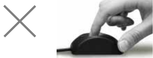
図 2.指の一部しかセンサに触れていない
