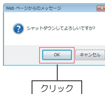
4.シャットダウン中の画面になり、“SYSTEM”ランプが点滅し始めます。
