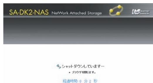
5. “SYSTEM”ランプと“POWER”ランプが消灯すると、シャットダウン完了です。
