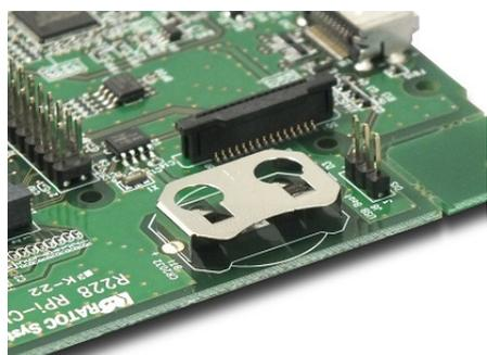
電池ホルダーに付属の CR2032 を接続することで、RTC をバックアップ。
