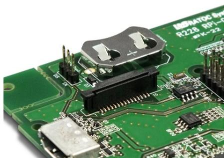
Raspberry-pi 標準のタッチパネルディスプレイ接続用 15pin DSI コネクタ。
